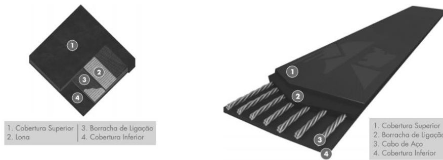
Figura 2.6. Componentes básicos de uma correia transportadora de lona (à esquerda) e de aço (à direita) (MERCÚRIO, s/d).
