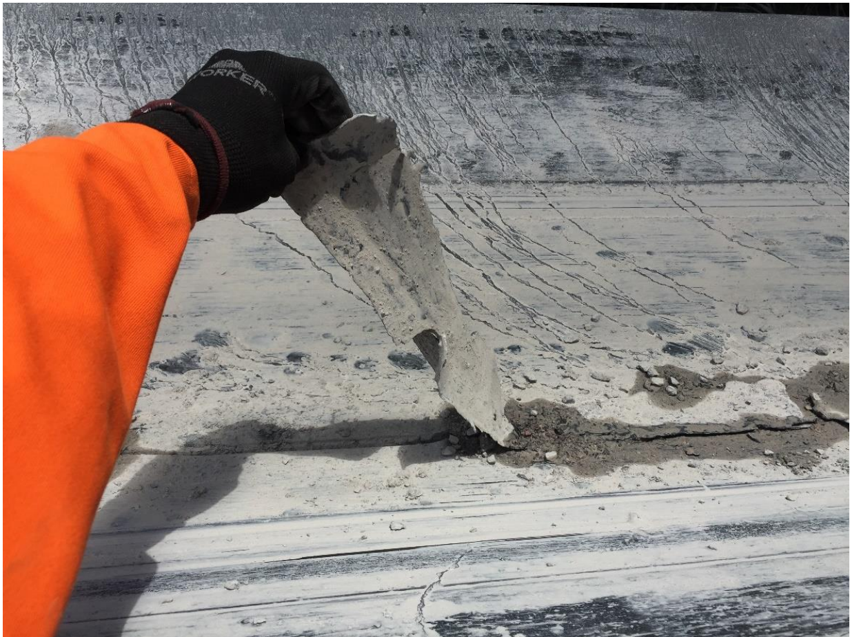
Figura 4.12 Desgaste da correia A1J05 (Arquivo Pessoal)
