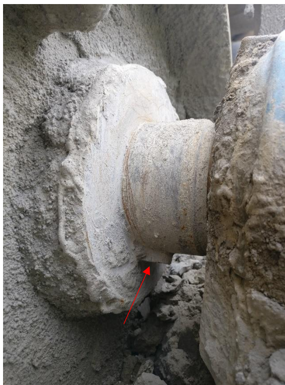
Figura 4.48 –Chaveta no eixo do rolo de dobra indicada por seta (Arquivo pessoal)
