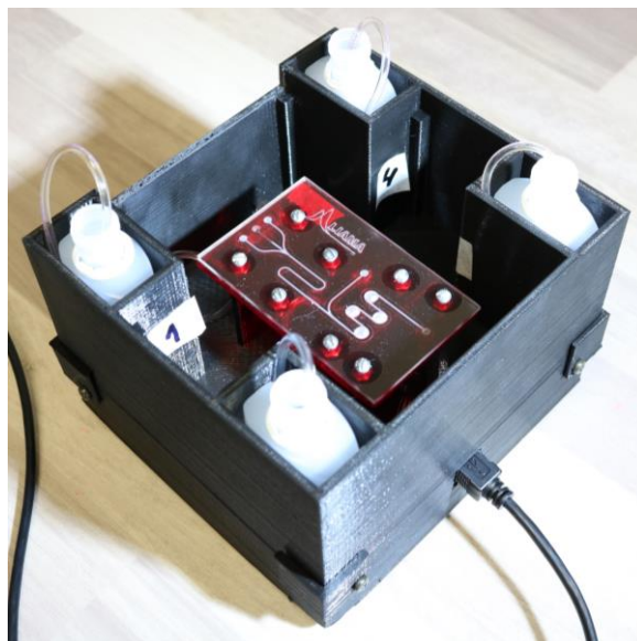
Figura 18 – Fotografia da parte superior da nova caixinha, onde são acomodados os frascos de armazenamento das soluções e o microdispositivo fluídico.
