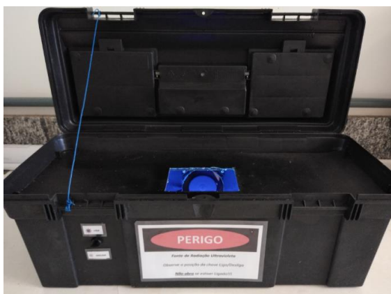
Figura 5 – Imagem da expositora lab-made empregada para exposição ultravioleta na etapa de gravação dos canais.
