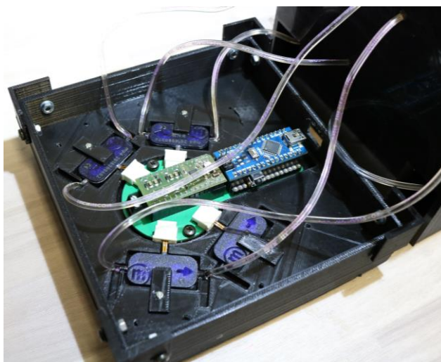
Figura 17 – Imagem da estrutura inferior da nova caixinha impressa em 3D comportando todo o sistema de controle das micro-bombas e as quatro micro-bombas com acionamento piezoelétrico.
