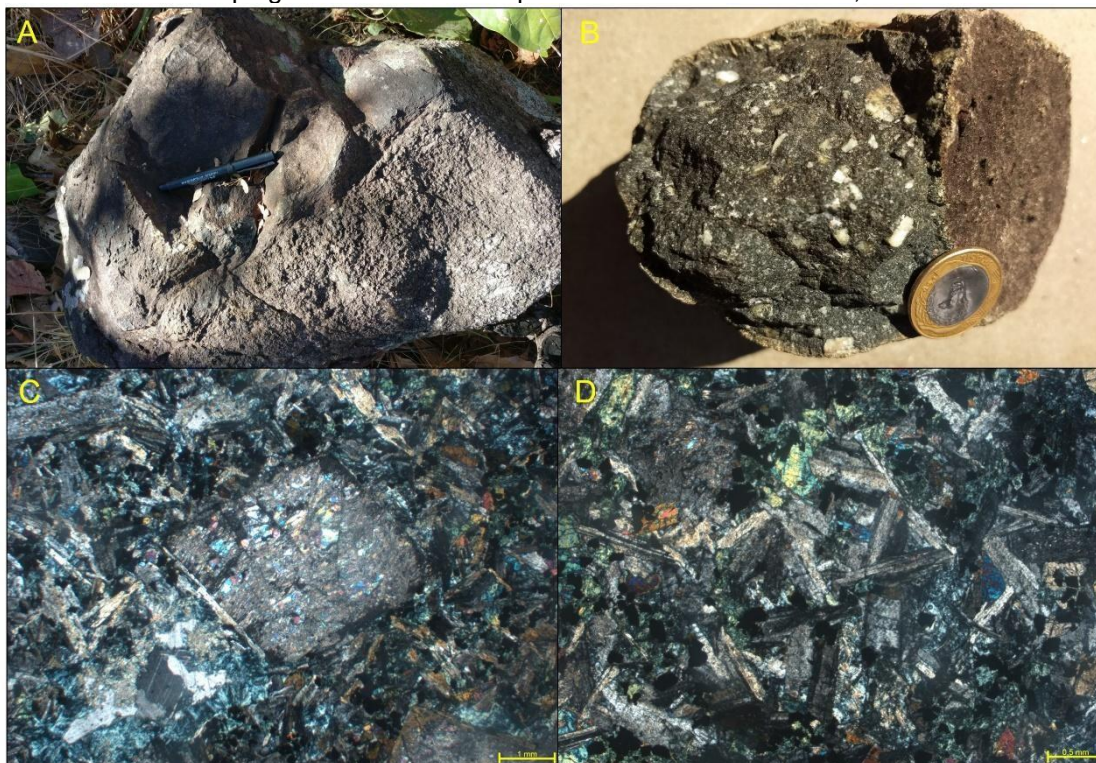
Figura 5.31. (A) Foto do afloramento em blocos do ponto TF18-IX-71, (B) foto da amostra macroscópica. Fotomicrografias das amostras de diabásio (C) com mineralogia composta por fenocristais de plagioclásio alterando para sericita e piroxênios como titiano-augita em aumento de 1,25x, (D) detalhe de textura subofítica com cristais de plagioclásio contido em piroxênios em aumento de 2,5x.
