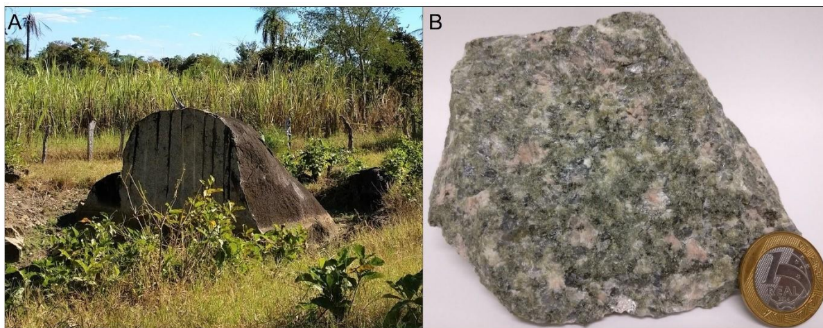
Figura 6.3. (A) Afloramento do granito com exposição de bloco implodido para amostragem para avaliação do uso como revestimento e pedra ornamental. (B) Detalhe da amostra de granito.
