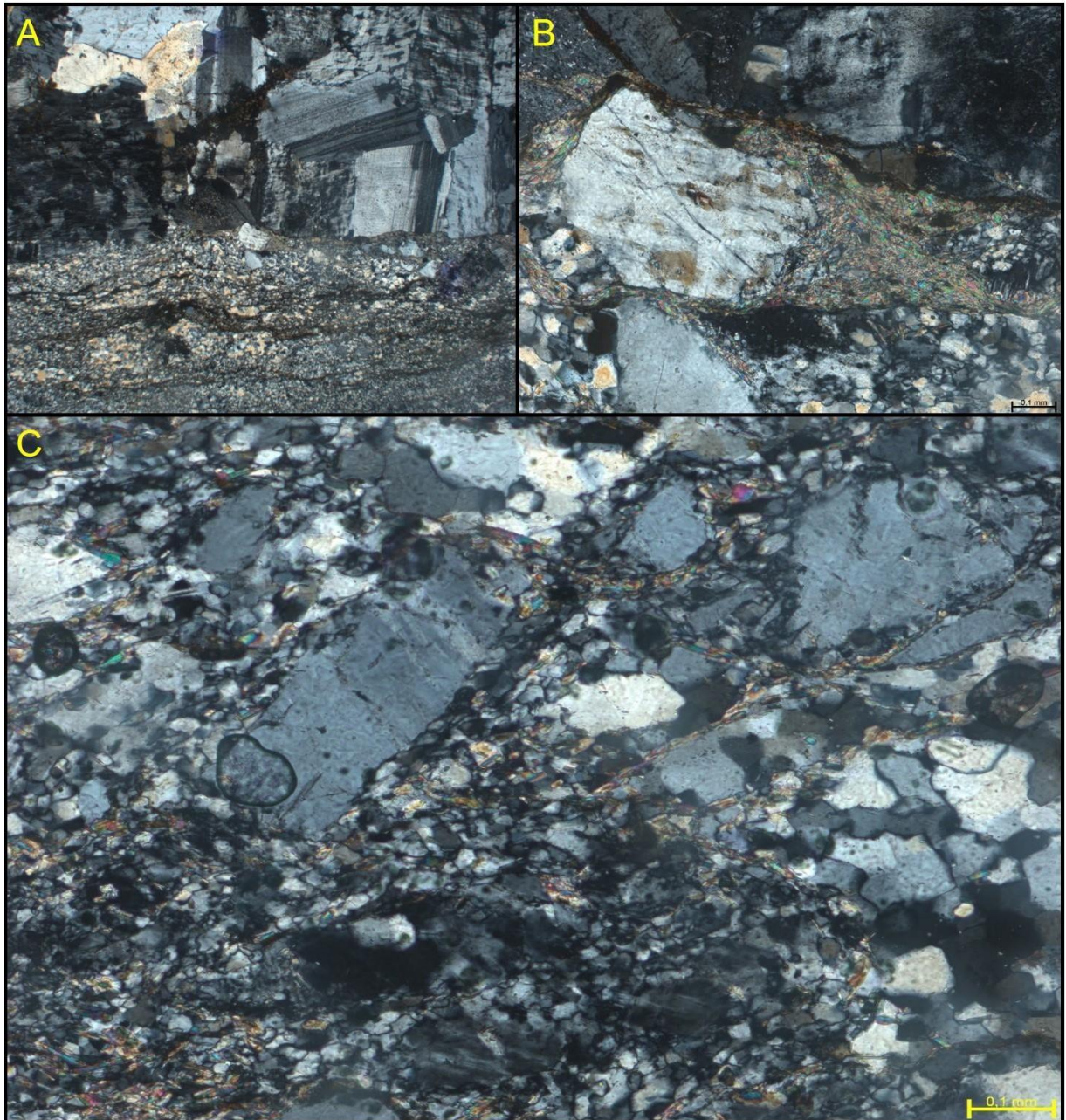
Figura 5.44. Fotomicrografia da lâmina TF18-IX-102, (A) exibindo o contato abrupto entre o milonito (parte inferior) e o granito (parte superior). É evidente a diminuição da granulação do milonito em comparação com a sua encaixante. Aumento de 1,25x. (B) Detalhe do milonito, mostrando porfiroclasto de feldspato deflectando a foliação dos filossilicatos, gerando sombra de pressão. Aumento de 2,5x. E (C) detalhe da região milonitizada exibindo as três diferentes granulações dos cristais de quartzo e feldspatos: porfiroclastos em meio a uma matriz mais fina, e ao lado, agregados de grãos de tamanhos intermediários. Aumento de 2,5x.
