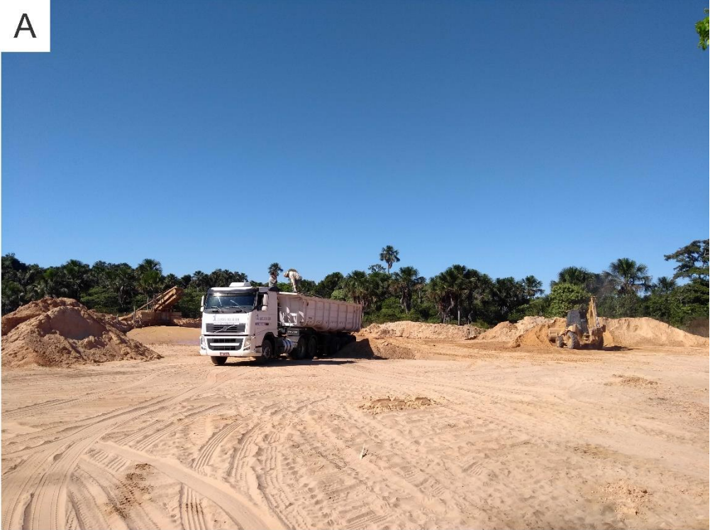
Figura 55. A) e B) Exploração de areia na área XVIII, com aproximadamente dez metros de espessura de areia média, lavada, com dragagem.
