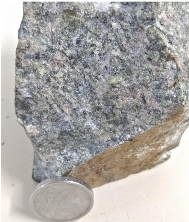
Figura 4.6: Amostra de mão de granodiorito. E diagrama QAP gerado a partir da geoquímica da amostra TF18_XIII_006.
