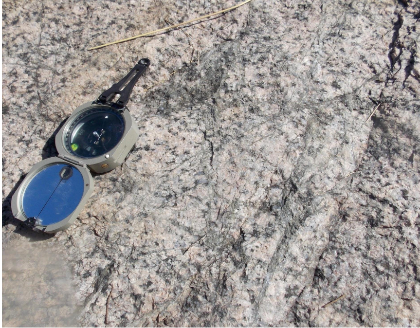
Figura 4.34: Afloramento de monzogranito em deformação rúptil, onde a brechação gerou proto-cataclase.
