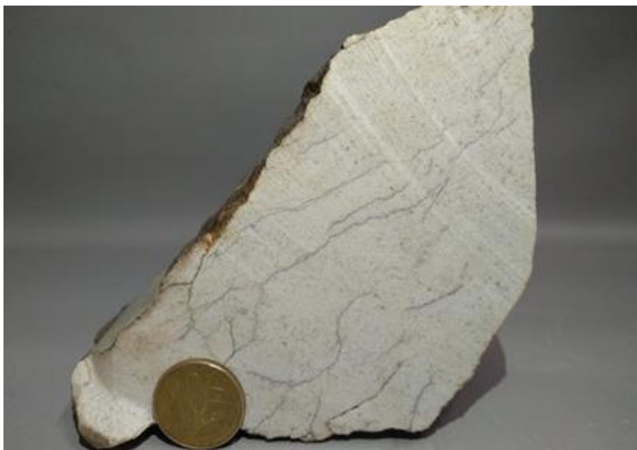
Figura 4.36: Quartzito micáceo protomilonítico do ponto 43 da Subárea XVI evidenciando intenso microfraturamento.
