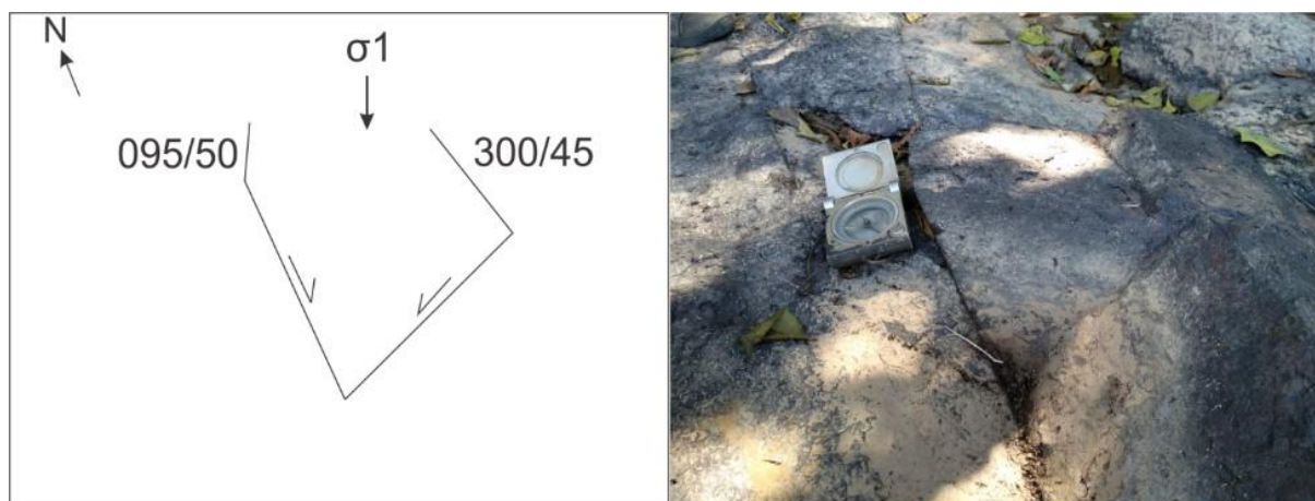
Figura 4.75. Fraturas de cisalhamento em biotita-sienogranito.
