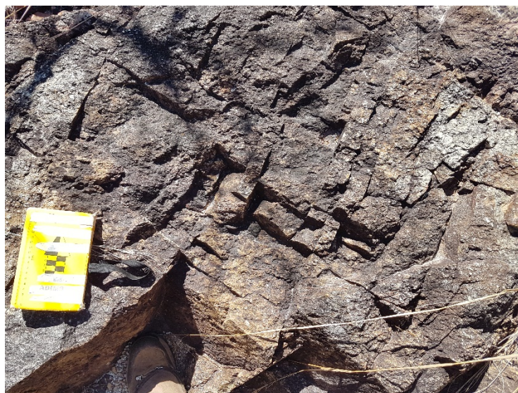
Figura 71 - Fraturas perpendiculares em vulcânica básica da unidade vulcânica máfica-ultramáfica acamadada com espaçamento decimétrico (Ponto 128).
