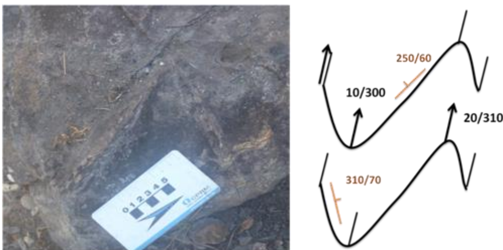
Figura 4.33 - Dobra fechada de escala da 7 cm, TF18-XV-23. Esquema indica medidas de Sn em laranja e eixos de dobras em setas pretas.
