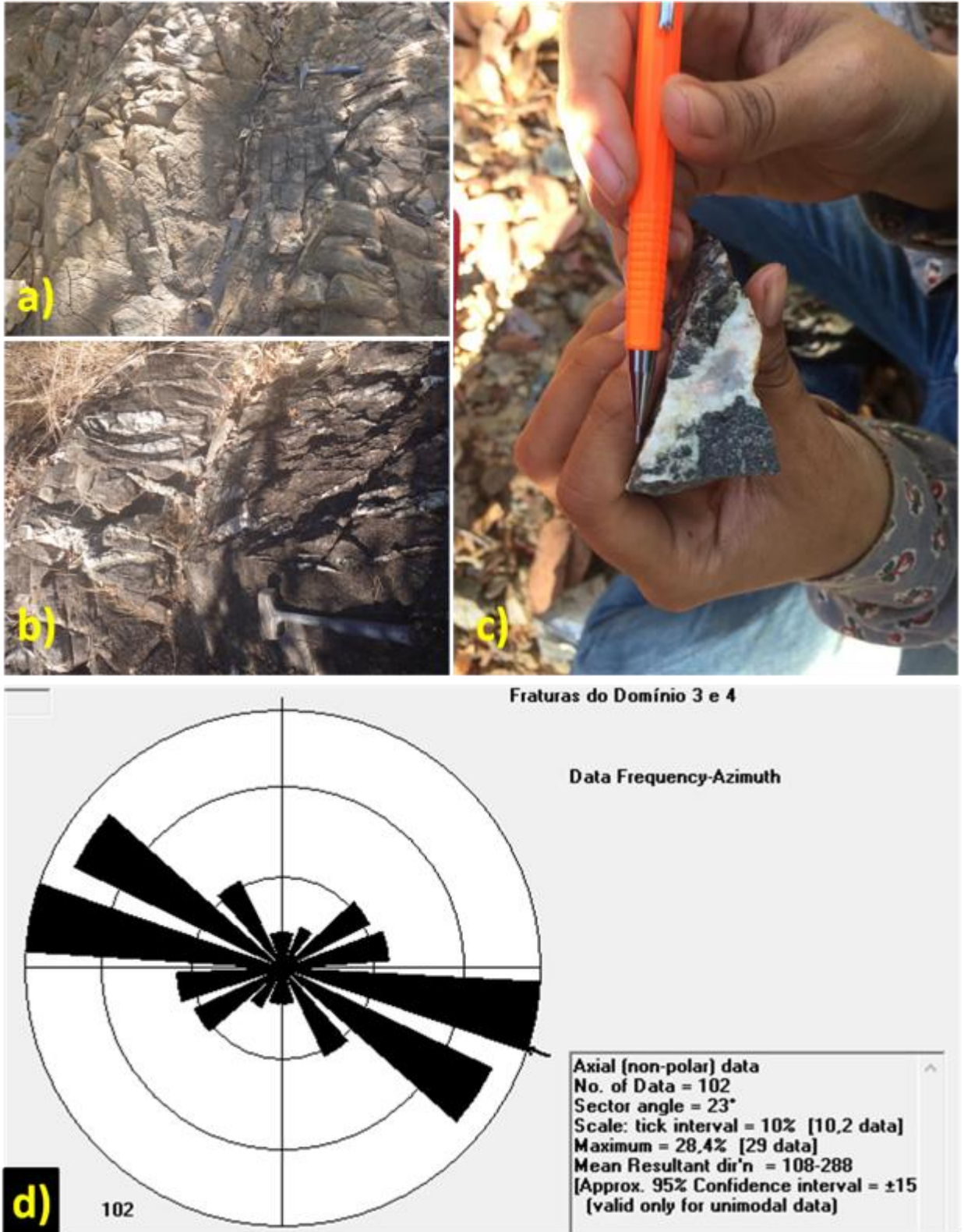
Figura 4.36 - Morfologias de fraturas. a) Afloramento TF18-XV-143 o qual afloram metariolitos com fraturas em pares conjugados de trend 130° e 73°. b) Afloramento TF18-XV-73 em que aflora granito com vênulas de quartzo singenético com trend 330°. c) Afloramento TF18-XV-180, amostra de mão coletada em lavra de garimpo com dois líquidos de preenchendo fraturas, silicático e carbonático. d) Roseta dos Domínios 3 e 4, com medidas de fraturas associadas as zonas de cisalhamento. Indica direção média 108.
