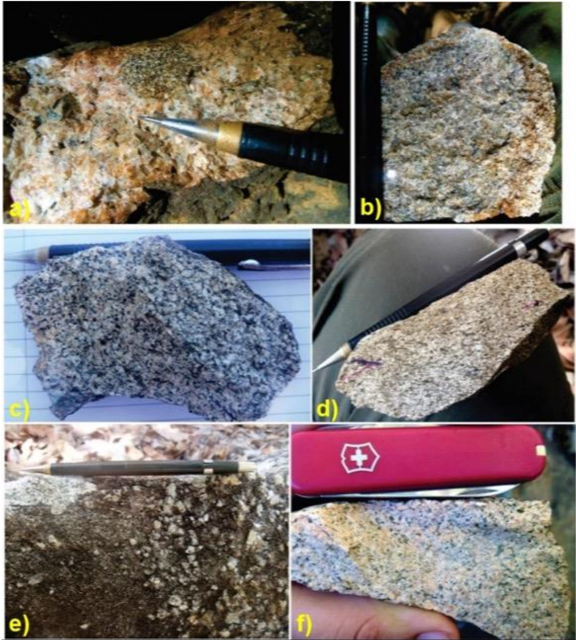
Figura 4.17 - a) Domínio pegmatítico de feldspatos; b) Rocha de coloração cinza rosado, de granulação fina a média, com composição sienogranítica e textura maciça; c, d) Granito Aroeiras mostrando suave foliação marcada pelas biotitas de direção 230^{\circ}/40^{\circ} ; e) Afloramento mostrando variação na granulação do granito, com domínio fino até grosso; f) Hornblenda monzogranito de coloração rosada, granulação fina e textura maciça.
