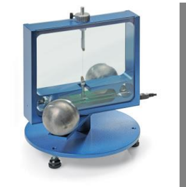
Figura 2 – Kit didático experimental para a medida de G Fonte: https://www.3bscientific.com.br (acesso em 15/05/2019)
