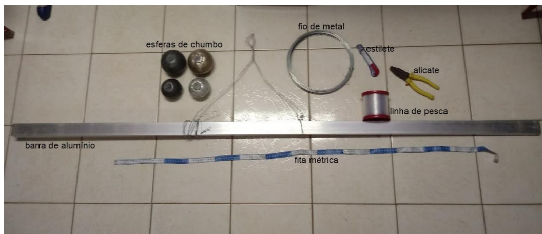
Figura 10 – Materiais para a construção do pêndulo Fonte: Tirada pela autora.
