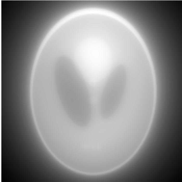
**Figura 2.6.** Fantoma de tamanho 513x513 reconstruído a partir de 500 ângulos utilizando Retroprojeção.
