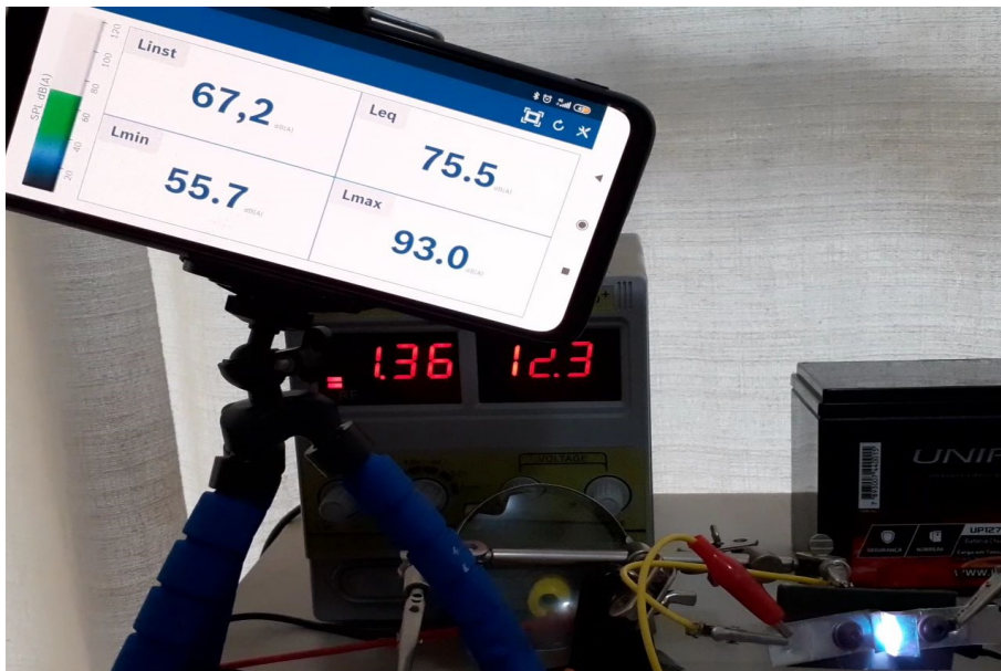
Figura 60 – Valor máximo em dB medido com o aplicativo iNVH para uma descarga com o conversor boost acoplado. A potência extraída da fonte de bancada neste teste foi de 16,73W.
