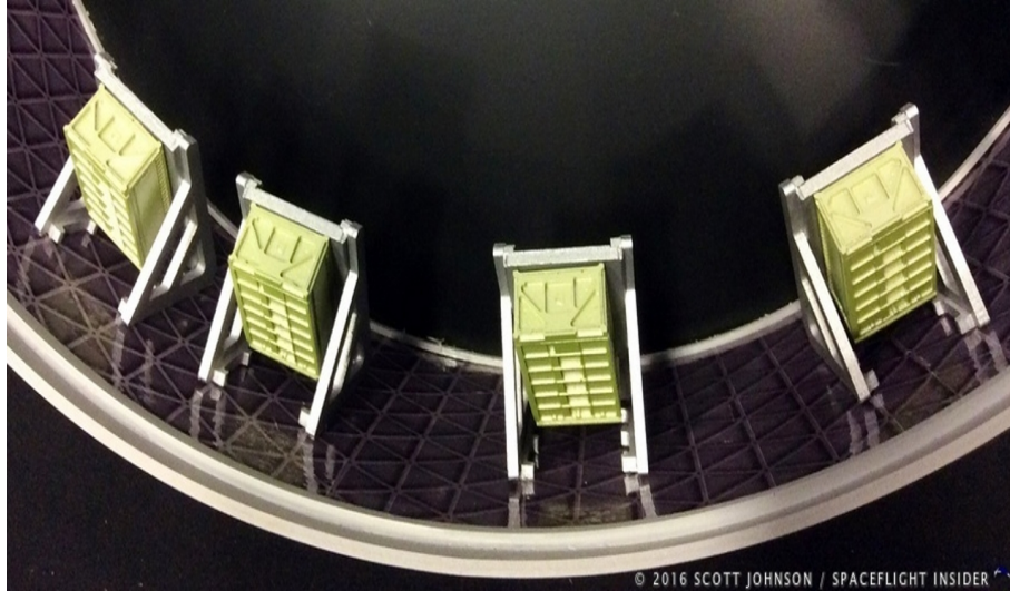
Figura 3 – Espaços reservados para CubeSats no veículo SLS da Nasa. Fonte: LATRELL .
