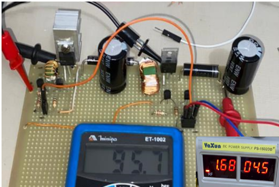
Figura 55 – Na figura podemos observar o circuito montado na placa perfurada, com os dissipadores menores. No detalhe é possível observar o valor de tensão e corrente da fonte de bancada, que está conectada à entrada do conversor, e o valor no multímetro mostrando a tensão de saída do mesmo, em 95.7 volts.
