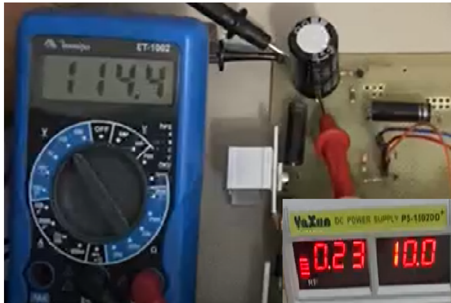
Figura 56 – O circuito do conversor boost obtendo uma tensão de saída de 114.4 volts, utilizando uma potência de entrada de 2.3W.
