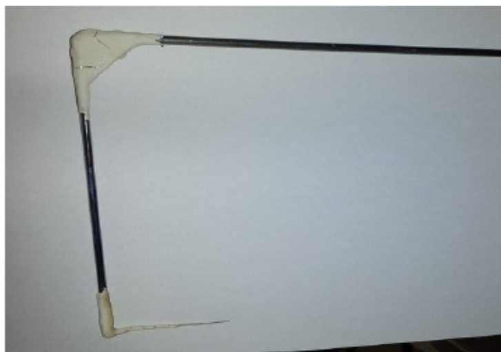
Figura 75 – Sonda de Langmuir utilizada para medições na região da corrente de Hall no PHALL IIC.
