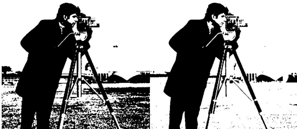
Figura 10 – Resultados obtidos após binarização global comum (esquerda) e binarização de Otsu (direita).
