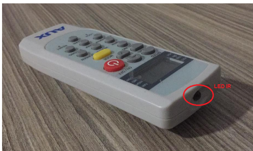
Figura 2.2. LED emissor IR utilizado em um controle de ar condicionado para transmissão de dados. Fonte: [6]
