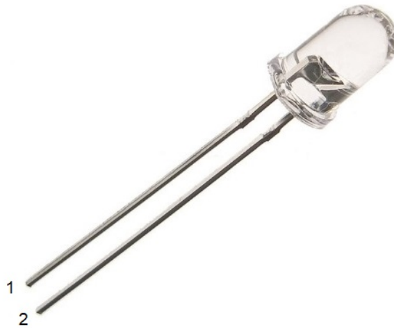
Figura 2.8. LED emissor de infravermelho utilizado para transmitir o sinal para o dispositivo receptor a ser controlado. Fonte: [1]
