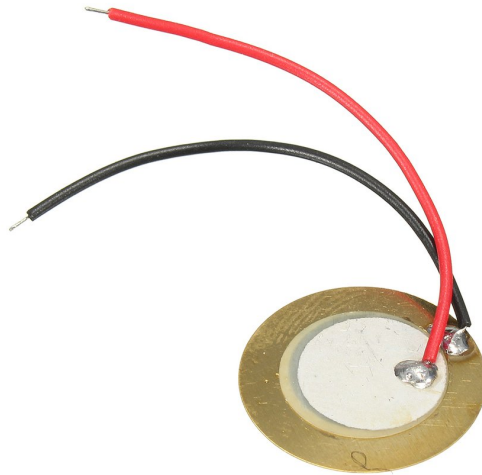
Figura 4.20. Piezoelétrico utilizado para detectar vibração do ar condicionado quando ligado. Fonte: Elaborada pelo autor. FONTE: [16]
