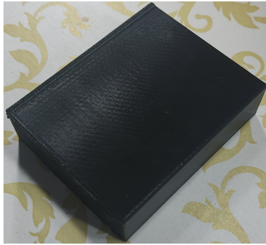
Figura 4.23. Caixinha impressa na impressora 3D para ser colada com fita dupla face 3M no ar condicionado com a PCB dentro. Fonte: Elaborada pelo autor.
