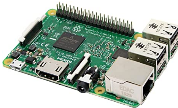
Figura 2.10. Placa Raspberry Pi 3 Modelo B que será utilizado como computador central com interface web entre o usuário e o cliente [13].
