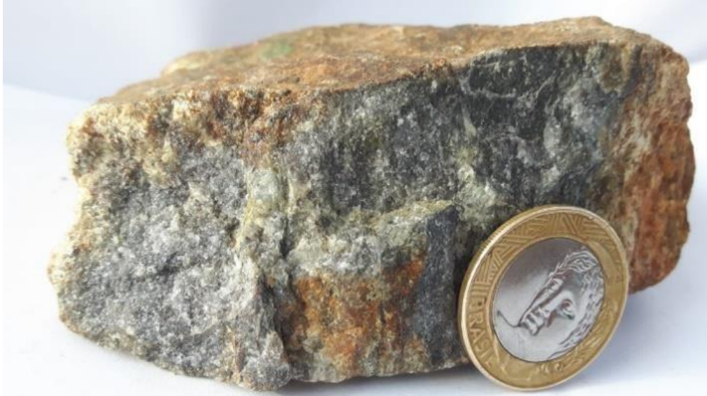
Figura 4.9: Macroscopia da unidade paraderivada Complexo Porto Nacional TF18-X-44. Amostra de mão do litotipo gnaissico paraderivado sillimanita-biotita-granda gnaisse (TF18-X-44). Trata-se de uma rocha aparentemente maciça, de granulação fina, equigranular de coloração escura, a textura que predomina é a granoblastica. Nota-se o intenso processo de recristalização.
