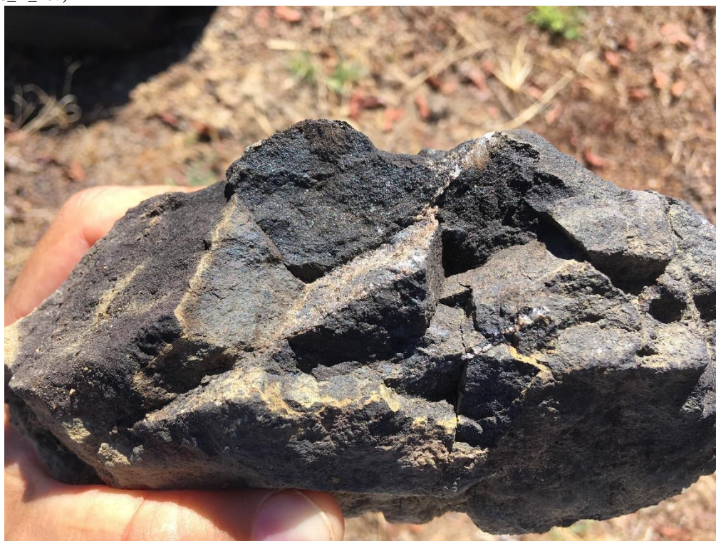
Figura 5.3: Gondito com bandas milimétricas de quartzo, pequenos cristais de granada e bolsões de grafita (Ponto: TF18_X_167)
