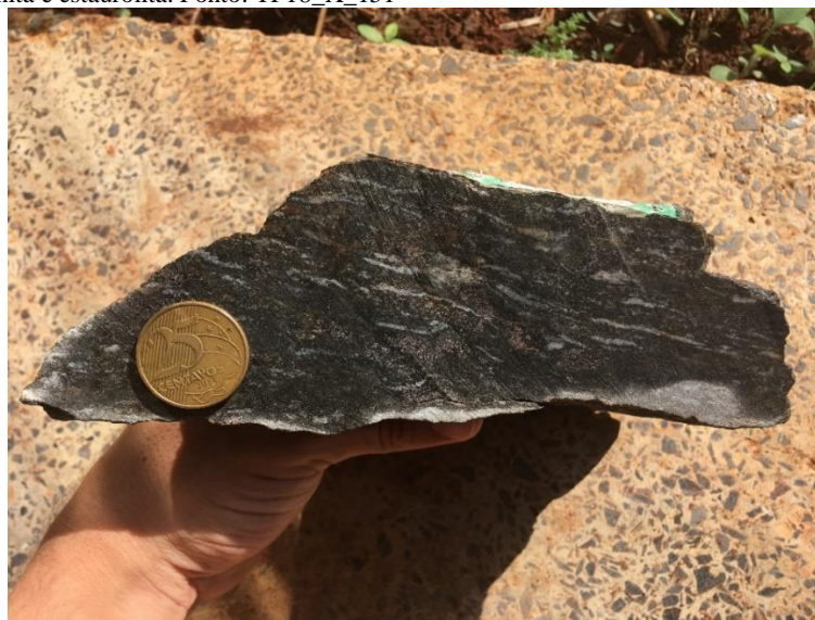
Figura 4.37: Amostra do paragnaisse do Complexo Porto Nacional. Foliação de alto grau gerando um bandamento descontínuo com bandas quartzo-feldspáticas e bandas milimétricas, máficas com biotita, anfibólio e granada. Seguido por vezes de cristais de silimanita e estauroлита. Ponto: TF18_X_151
