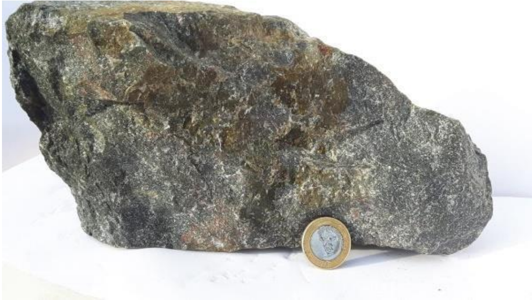
Figura 4.15: Rocha calcissilicática da intrusiva carreira comprida: Aspectos macroscópicos desse litotipo. A) trata-se de uma unidade de estrutura maciça, granulação fina, coloração escura, alta dureza, intensamente recristalizada, textura granoblastica. As fases minerais mais presentes são cristais de plagioclásio, quartzo e granada, sendo os cristais máficos/acessórios de difícil caracterização em função do intenso retrabalhamento e granulação da rocha.
