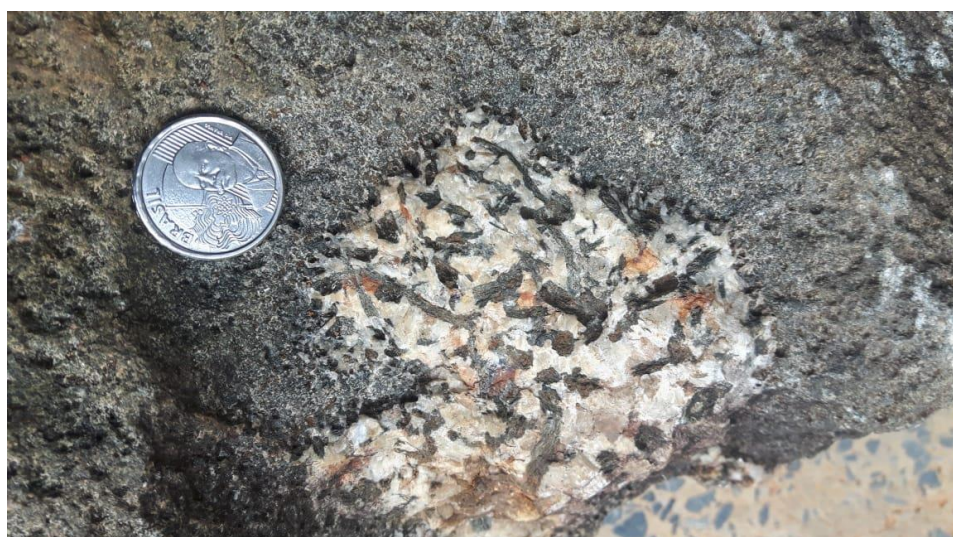
Figura 4.19: Macroscopia da intrusiva Morro da Mata e composição química, TF18-X-27. Aspecto textural/composicional contrastante nas rochas da suíte intrusiva morro da mata encontrada nos domínios da subárea X. Tal processo seguramente marca um contraste da taxa de difusão das fases minerais hornblenda e plagioclásio de granulação grossa imersos em um arcabouço gabroico de granulação fina. Pode-se sugerir também uma componente de imiscibilidade magmática, fracionando líquidos de diferentes teores de sílica. Nota-se também ,a direita, a composição dos elementos maiores para essa unidade.
