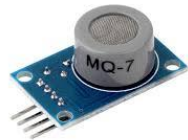
Figura 10 - Sensor MQ-7 (Monóxido de Carbono)
