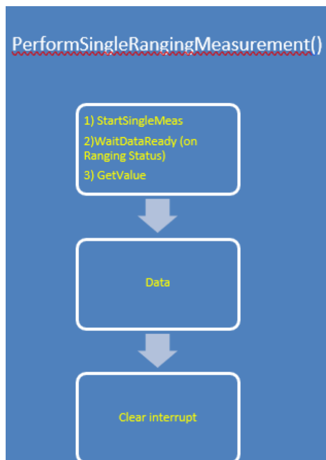
Figura 2.28: Diagrama de Medição Pausada por Polling Controlada pela API
