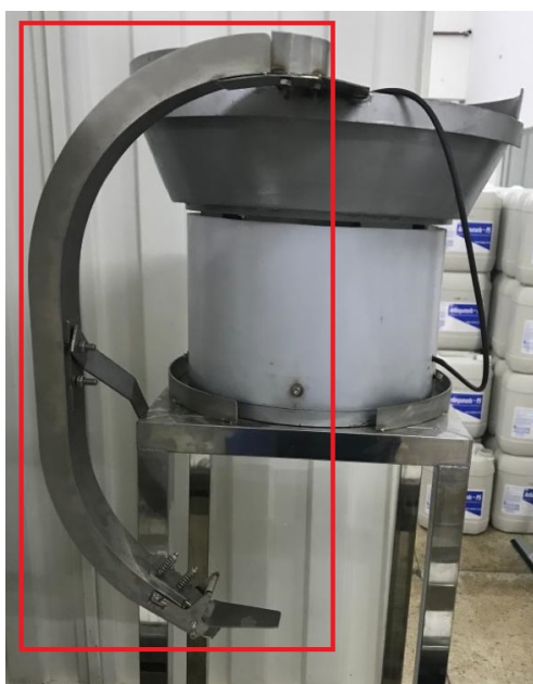
Figura 4.6: Calha que realiza a inserção das tampas nas garrafas junto do alimentador vibratório.
