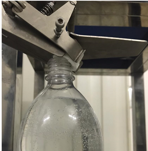
Figura 4.11: Peça responsável pela inserção das tampas nas garrafas PET
