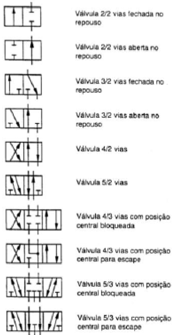
Figura 2.19: Simbologia de algumas válvulas direcionais pneumáticas [11].
