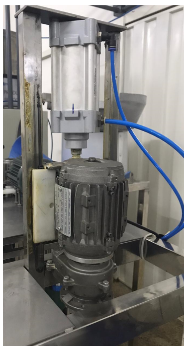
Figura 4.14: Motor e cilindro pneumático utilizados no rosqueamento de garrafas de 20L.
