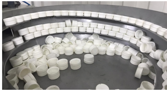
Figura 4.7: Guias laterais da panela cascata que permitem que as tampas cheguem até o topo da estrutura
