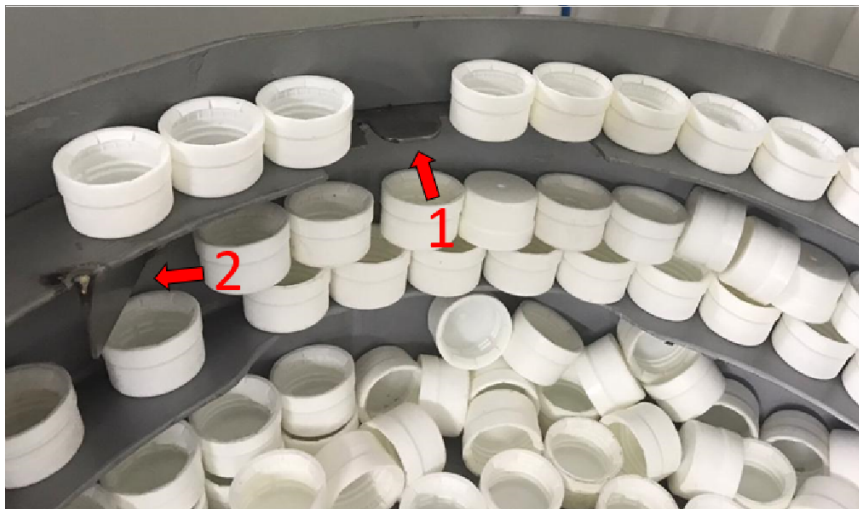
Figura 4.8: Obstáculos internos da panela cascata que permitem o correto posicionamento das tampas.
