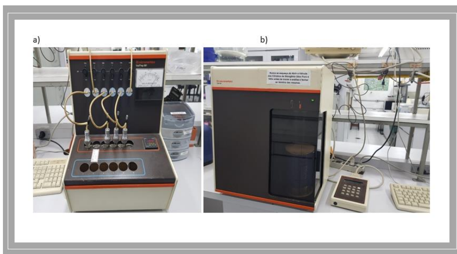
Figura 16- Departamento de Engenharia Metalúrgica e Materiais da Escola Politécnica da Universidade de São Paulo no Laboratório de Processamento Cerâmico (a) Sistema de pré-tratamento das amostras VacPrep061 (b) Analisador de Área de Superfície Micrometrics Gemini III2375
