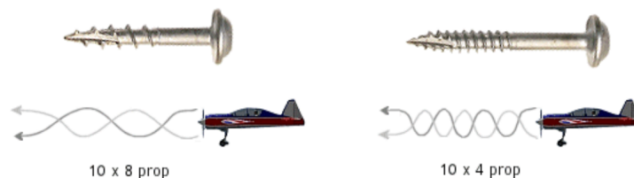
Figura 4.1: Analogia entre passo de parafuso e passo de hélice [3]
