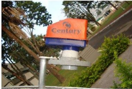
Montagem do LNBF no disco e fixação no suporte de LNBF
