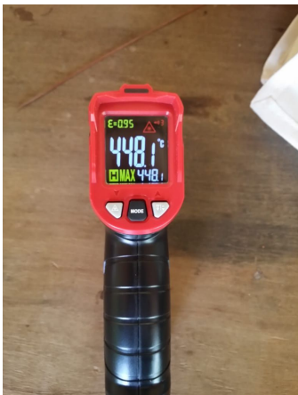
Figura 4.11 - À esquerda, a temperatura interna máxima do absorvedor de calor sem circulação de água medida pelo sensor infravermelho TA601A. À direita, a tabela com os valores de temperatura de estagnação obtidos por KAUSHIKA (1999).
