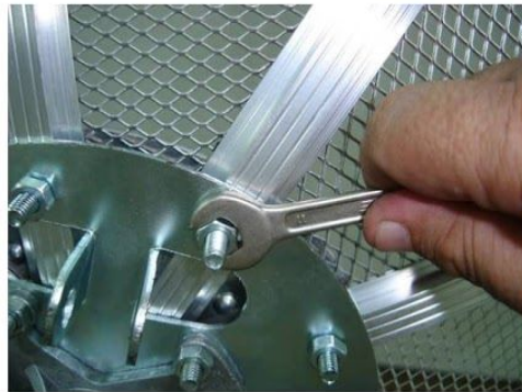
Aperto final no disco – Não esmagar a ponta da longarina
