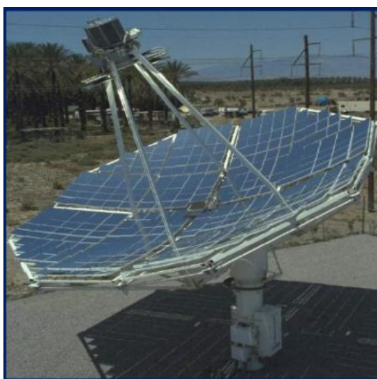
Figura 2.8 - Sistema Advanco Vanguard (CIEMAT, 2009 apud CASTELLANOS, 2012).
