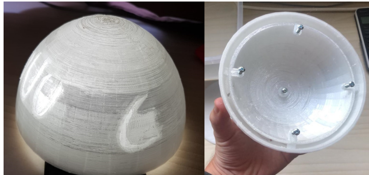
Figura 10 – Protótipo dos controladores impresso.
