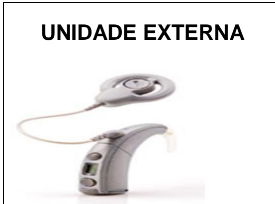
Figura 03: unidade externa do implante coclear
