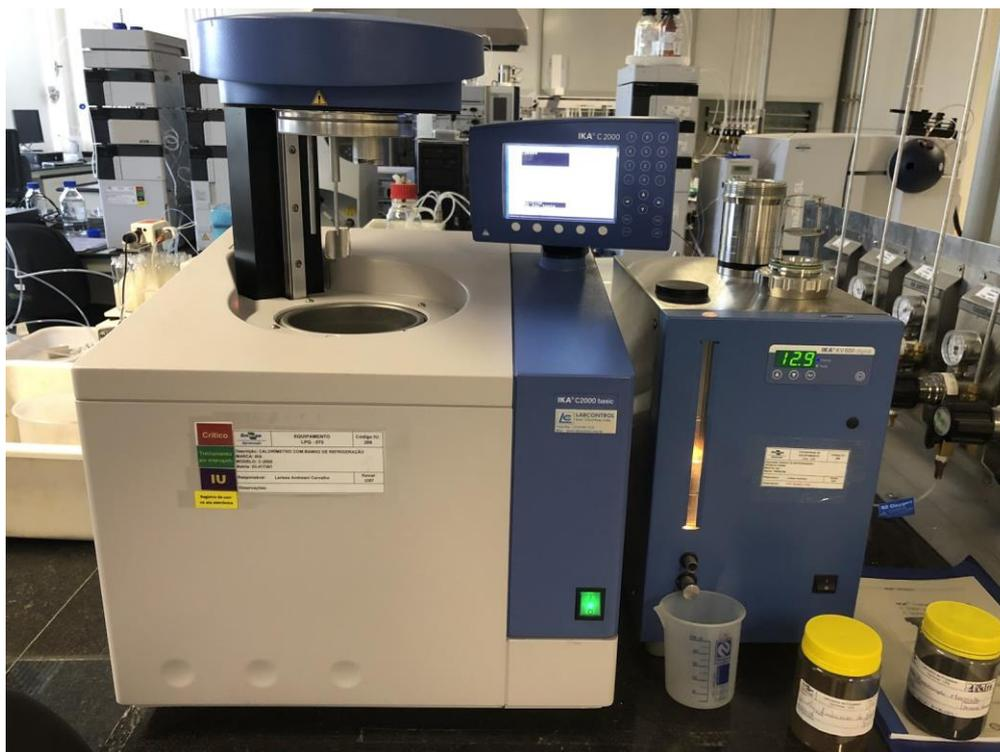
Figura 11. Calorímetro com banho de refrigeração C-2000 (marca IKA)
