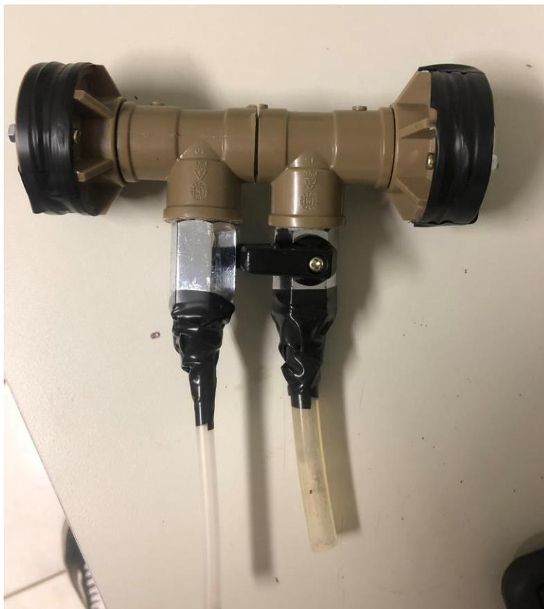
Figura 24. Célula de gás de baixo custo para análise no infravermelho.
