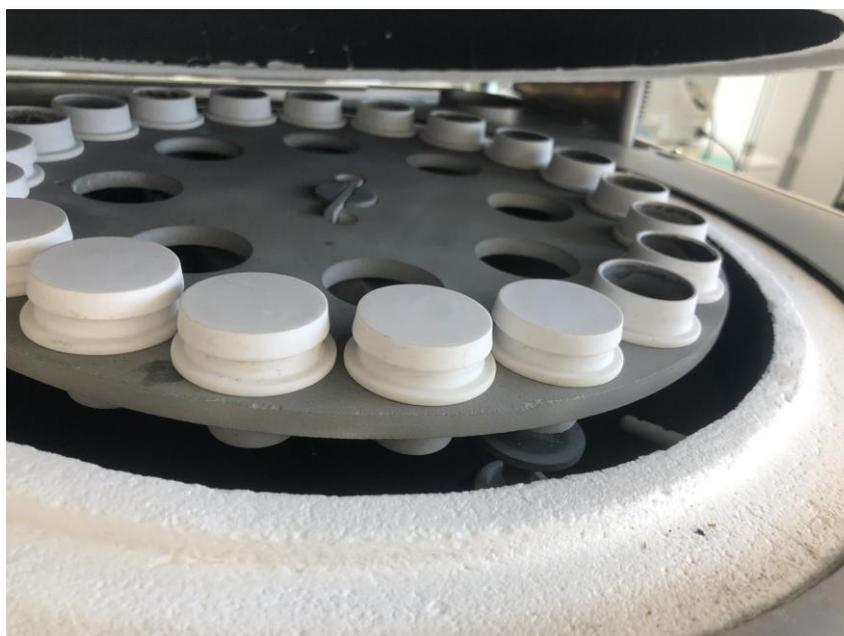
Figura 13. Cadinhos no analisador termogravimétrico.
