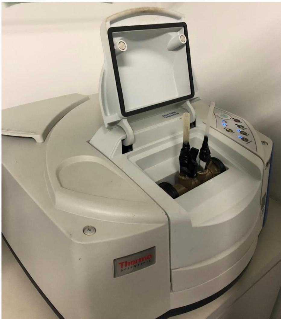
Figura 25. Célula de gás acoplado ao Espectrômetro de Infravermelho por Transformada de Fourier Thermofisher Nicolet iS10.
