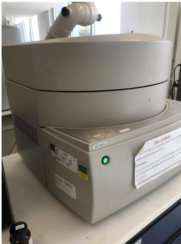
Figura 12. Analisador Termogravimétrico TGA-701 (marca Leco)
