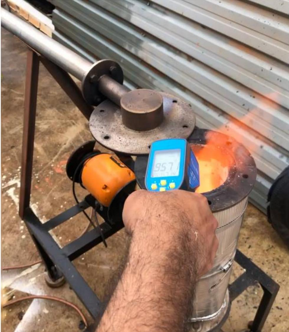
Figura 22. Medição da temperatura.
