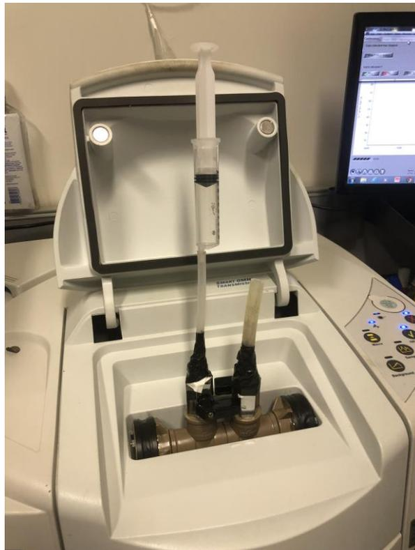
Figura 27. Utilização de seringas para a inserção do gás de síntese na célula.
