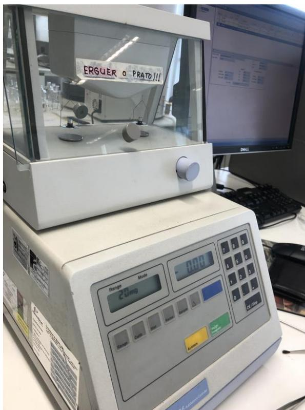
Figura 9. Balança analítica AD-6 Autobalance PerkinElmer
