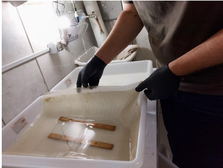
Figura 41 - aplicação de tratamento aquoso no suporte do álbum
