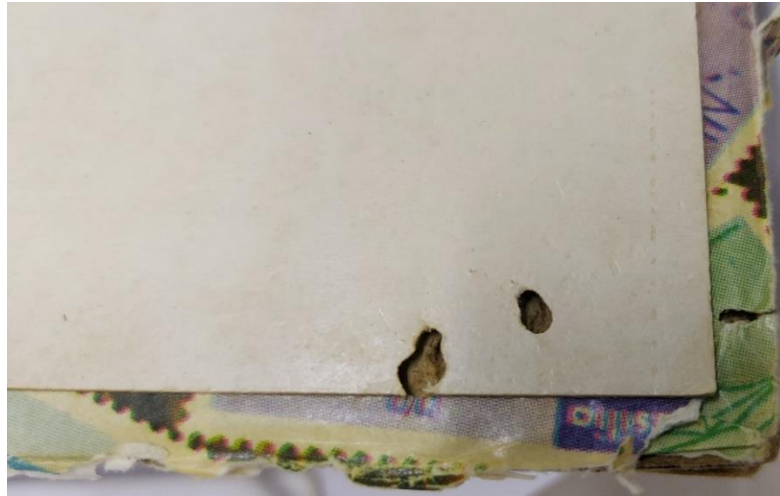
Figura 7 - Evidência de broca na capa
