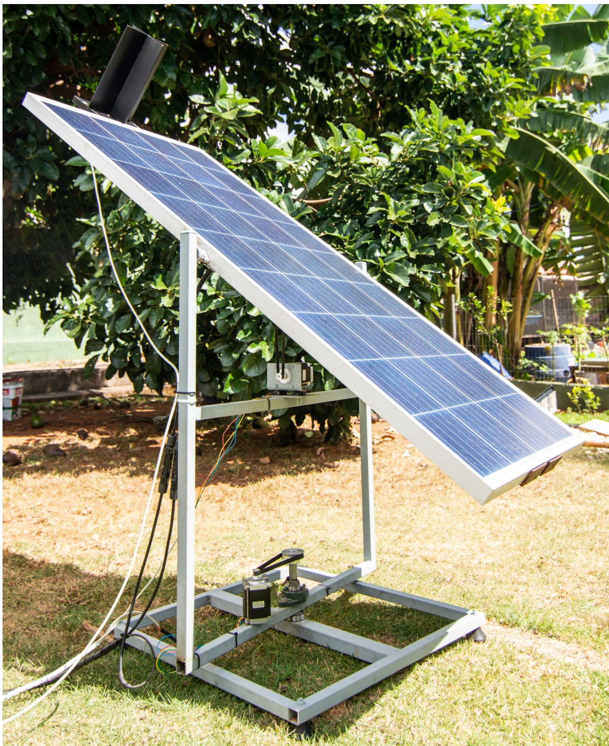
Figura 20. Foto do seguidor completo em funcionamento.(Autoria própria).
