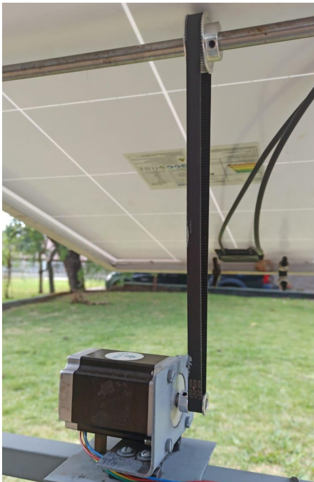
Figura 16. Foto do eixo horizontal, motor, correia e polias.(Autoria própria).
