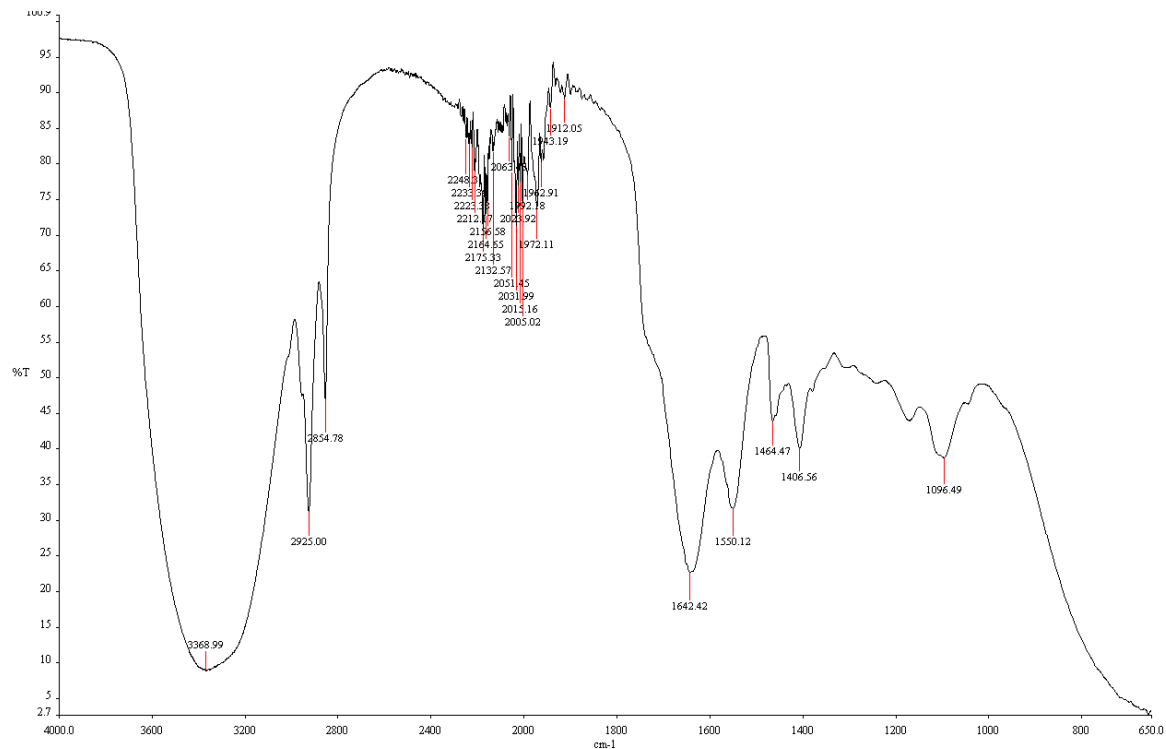
Figura 14 – Espectro de FTIR do diol do óleo da polpa da macaúba.
