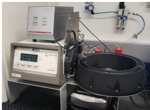
Figura 5– Imagem do analisador de viscosidade cinemática a 40°C e 100°C Stabinger SVM 3000.
