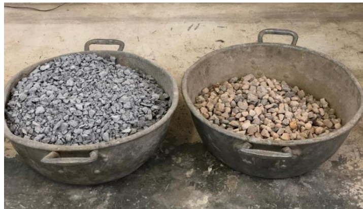
Figura 5: Comparação visual entre o agregado britado (à esquerda) e o agregado reciclado de concreto (ARC, à direita).
