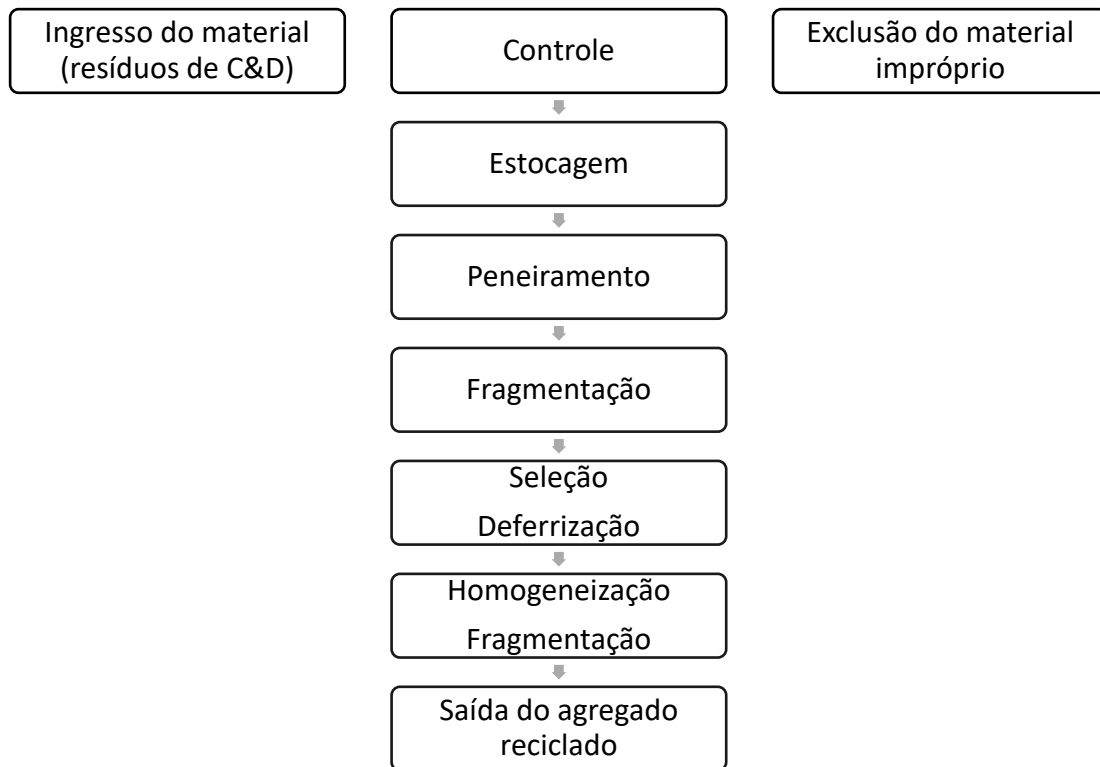
Figura 6: Esquema do processo de produção do ARC.
