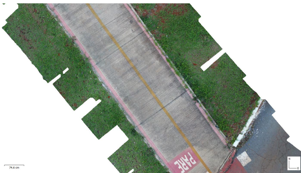
Figura 43 - Ortomosaico gerado em parte da ciclovia. Fonte: Autor, 2020.
