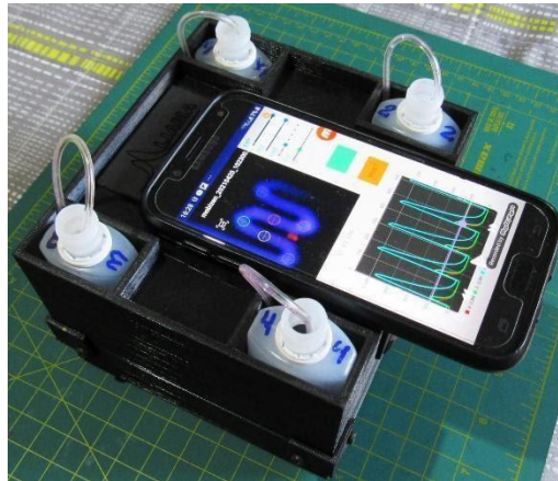
Figura 16: Fotografia do processo de quimiluminescência em execução no interior do microsistema sendo acompanhado pela câmera do smartphone acoplado
