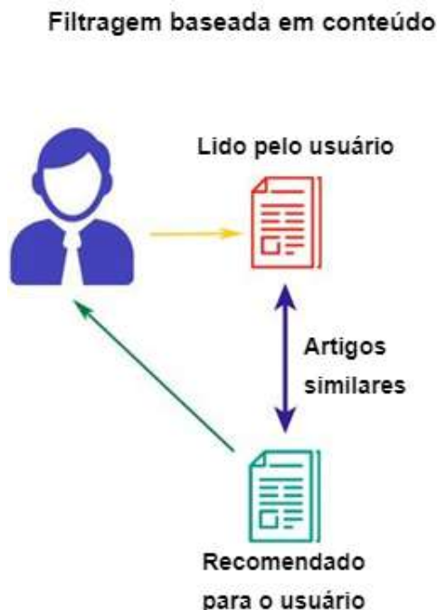
Figura 6 – Esquema do funcionamento da filtragem baseada em conteúdo. Fonte: (JAIN, 2019). Tradução livre pelos autores.
