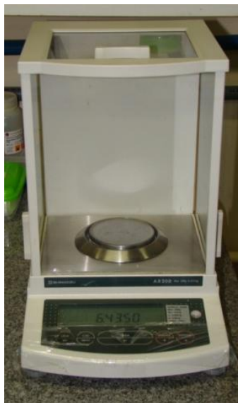
Figura 1. Foto: Luciano Paulino da Silva, EMBRAPA-CENARGEN, DF. Balança analítica digital utilizada para pesar as amostras de queijos.
