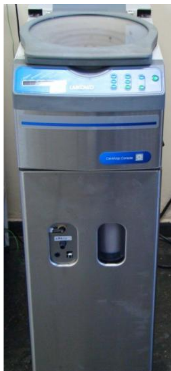
Figura 3. Foto: Luciano Paulino da Silva, EMBRAPA-CENARGEN, DF. Equipamento liofilizador tipo “Speed Vac”.
