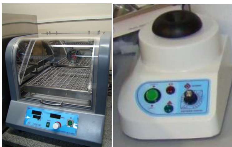
Figura 2. Foto: Luciano Paulino da Silva, EMBRAPA-CENARGEN, DF. Incubadora/Agitadora e vortex, respectivamente, utilizados para homogeneização das amostras durante o processo de extração de peptídeos.
