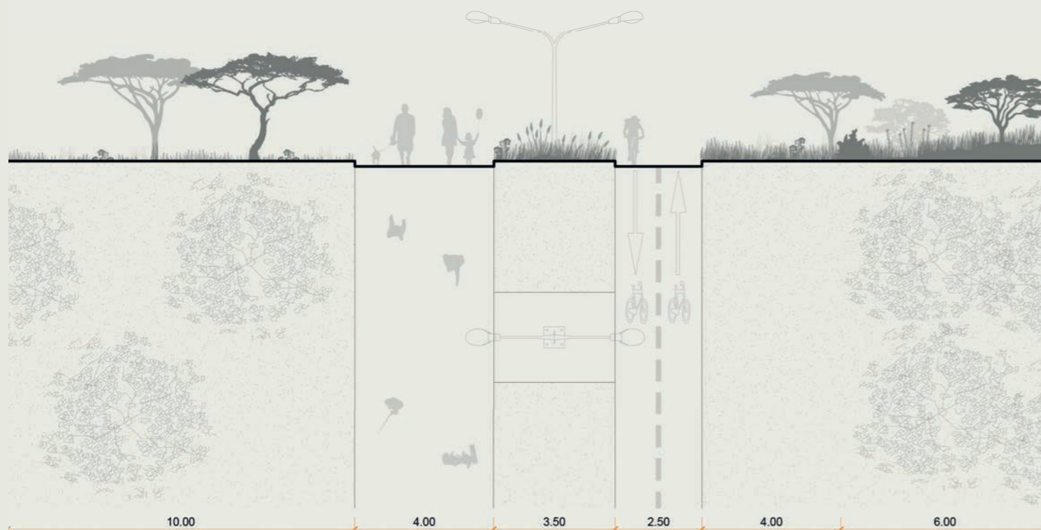
Figura 210. Seções viárias vias perimetrais e vias transversais
