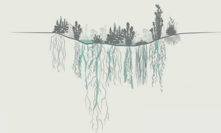
Figura 199. Configuração de jardim de chuva pela inclinação do terreno e uso de espécies resistentes ao alagamento
