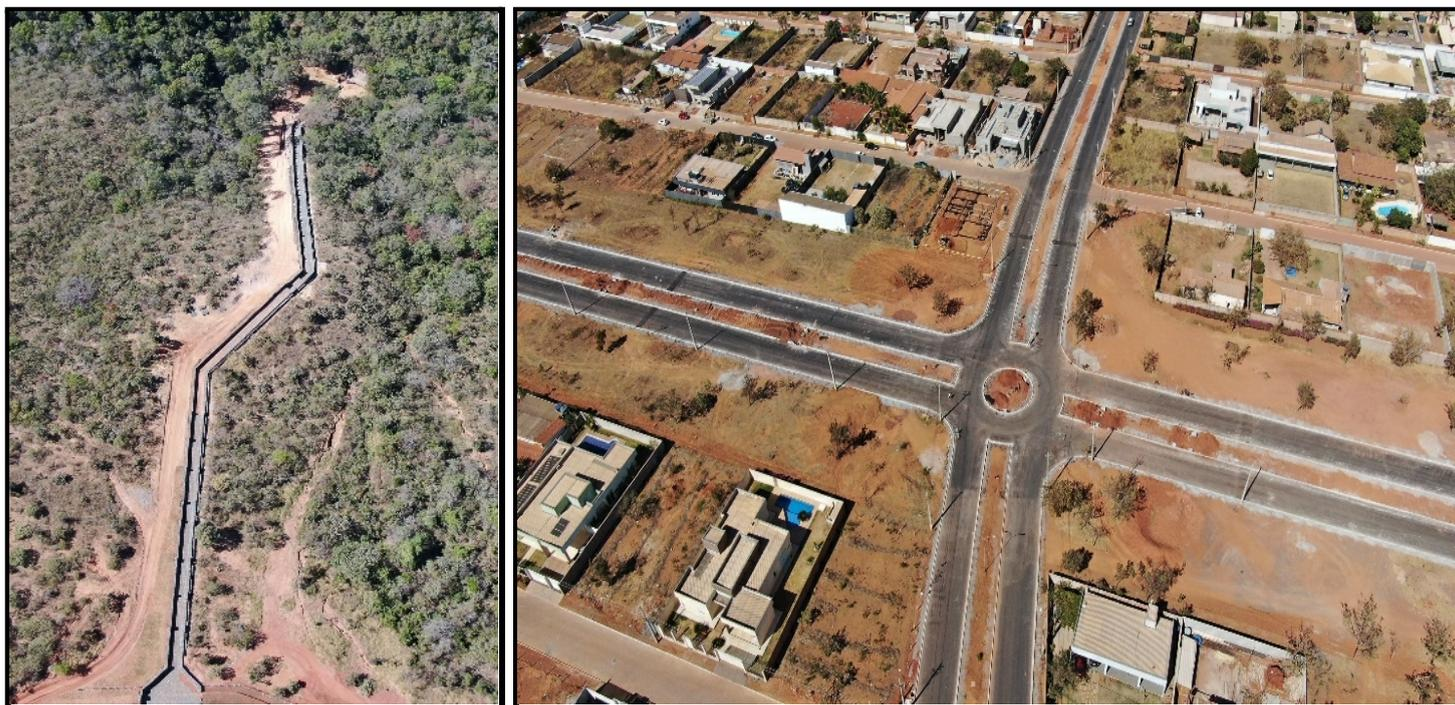
Figura 20 e 21: Imagem de drone do canal de drenagem que leva a água da bacia até o Córrego Taboquinha (Esquerda) e a pavimentação finalizada (Direita). Fonte: Condomínio Estância da Alvorada, c2021
