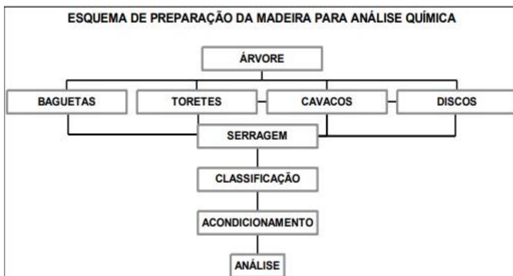
Figura 1. Esquema das etapas de preparação da madeira para análises químicas. Fonte: Klock & Andrade (2013).
