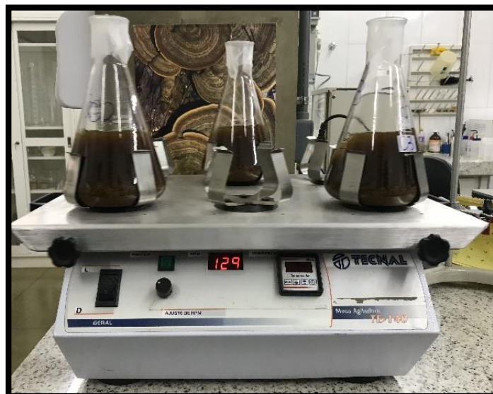
Figura 2. Mesa agitadora em processo de maceração das partículas de madeira com etanol absoluto. Foto: autora.
