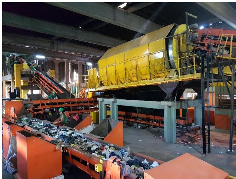
Figura 6-4: Separação mecanizada de material reciclável Fonte: (Tribunal de Contas do DF & Secretaria de auditoria, 2018)
