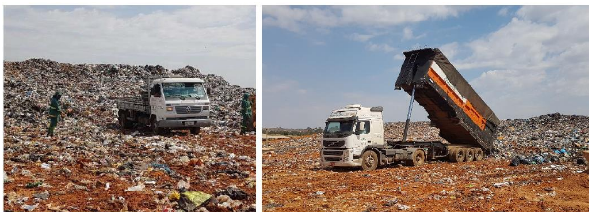
Figura 6-9: Caminhões descarregando os rejeitos finais
