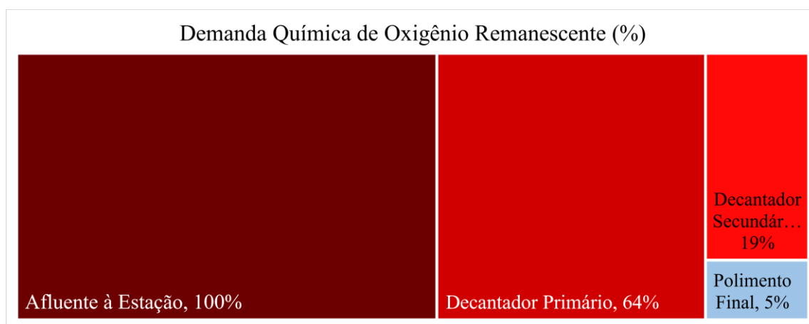
Figura 5.4 – DQO remanescente média (%) ao longo das etapas de tratamento no período de agosto de 2017 a outubro de 2020.
