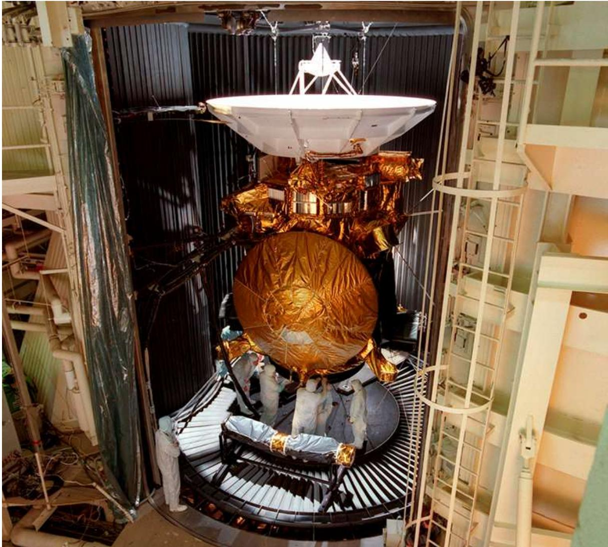
Figura 3.1 – Foto da espaçonave Cassini-Huygens durante a fase de teste térmico e de vibração. Na parte debaixo da figura, nota-se o tamanho da nave em comparação com as pessoas. Fonte: NASA/Jet Propulsion Laboratory – Caltech.
