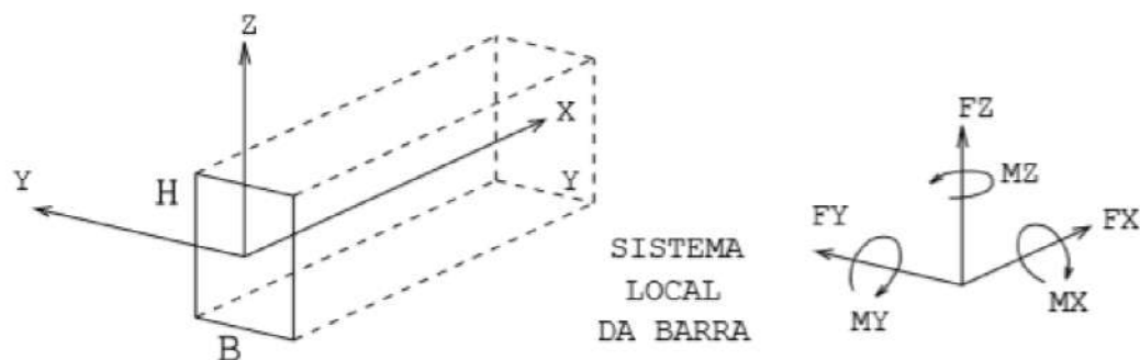
Figura 2.28 - Sistema local de coordenadas para cada barra do pórtico e da grelha
