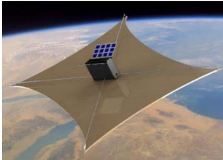
Figura 3 – Ilustração do CubeSat CIRES, na configuração com a antena estendida.
