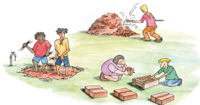
Figura 5: Processo de confecção dos Tijolos de Adobe Fonte: Ecocentro IPEC
