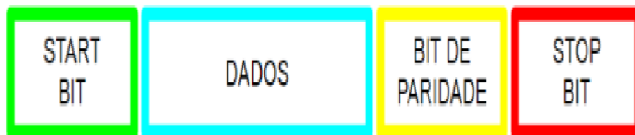
Figura 5 – Estrutura Básica de Transmissão Assíncrona.
