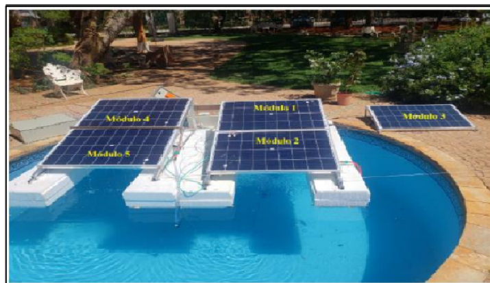
Figura 55 – Arranjos de Módulos Fotovoltaicos.
