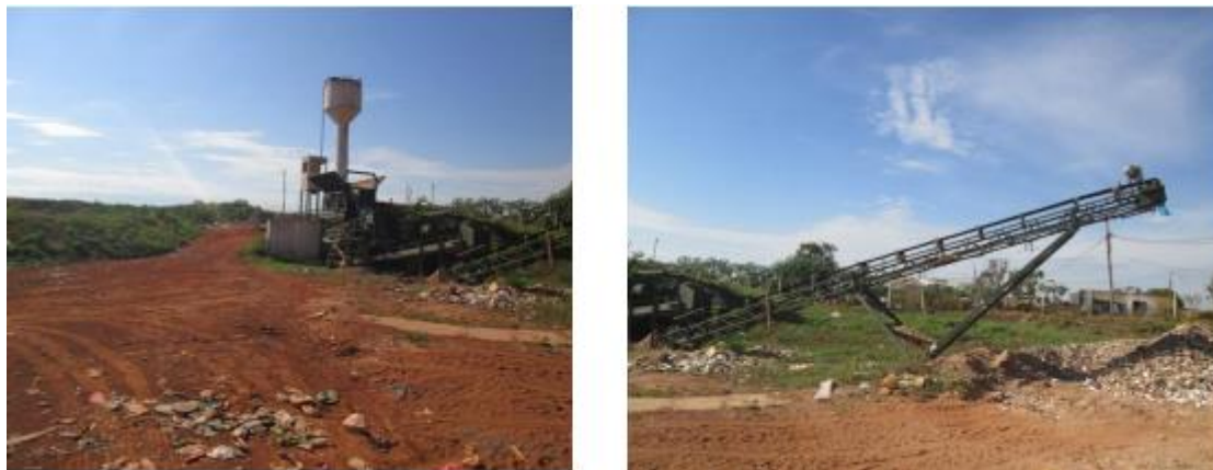
Figura 1 – Britador de RCC da Unidade de Recebimento de Entulhos (URE), localizada no antigo lixão da Estrutural – Aterro do Jóquei
