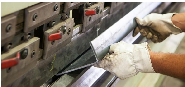
Figura 1-5 Dobradeira de chapa a frio. (Disponível em: www.indrofer.com.br , acesso em: 16 de abril de 2021)
