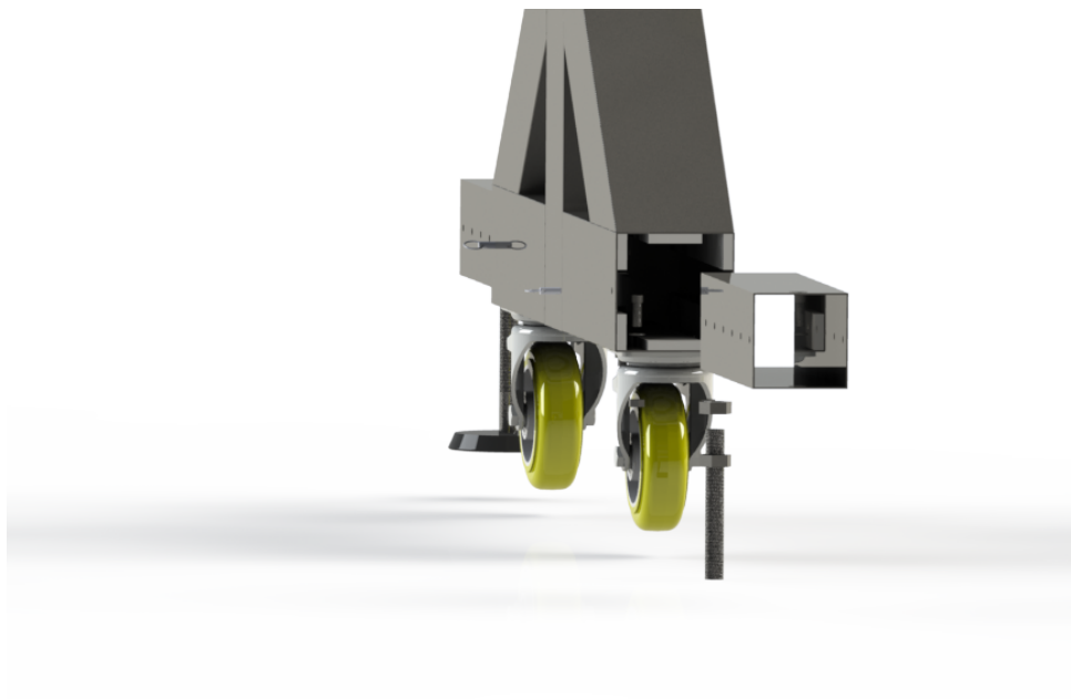
Figura 70: Vista explodida conexão tubo da base com tubo de suporte da sapata Fonte: Autor
