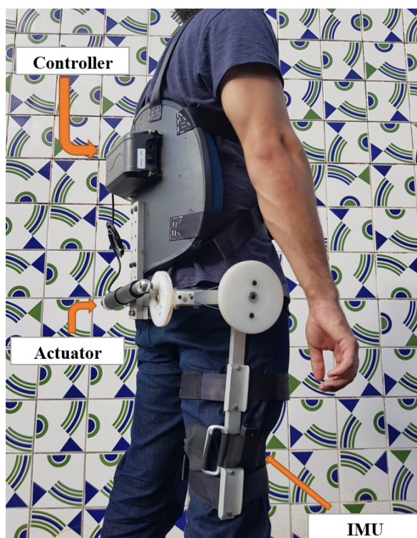
Figura 2: Exoesqueleto com atuação direta no quadril do Projeto TAO. Fonte: FREIRE, 2019
