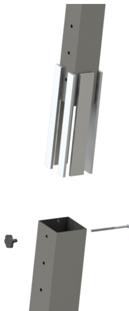
Figura 69: Vista explodida conexão parte superior com inferior Fonte: Autor
