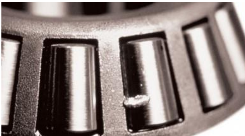
Figura 2-3 - Falha localizada na pista interna de um mancal de esferas.
