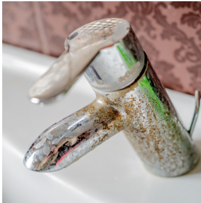
Figura 1 – Torneira com incrustações e oxidação (CANVA, 2020).
