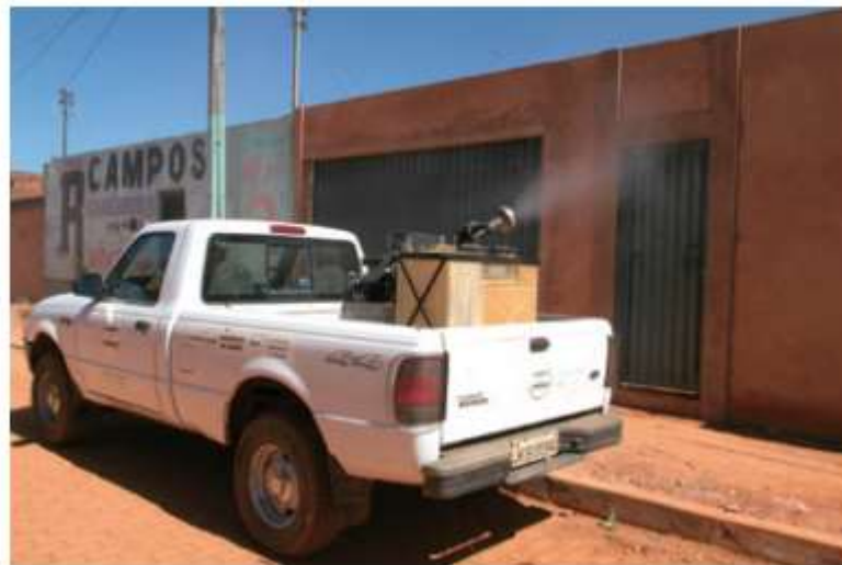
Figura 5 - Ilustração da técnica de nebulização a Ultra Baixo Volume veicular. Fonte: Diretrizes Nacionais para a Prevenção e Controle de Epidemias de Dengue.
