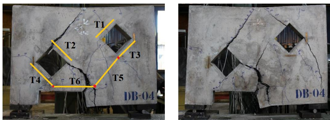
Figura 4. 19 – Modo de ruptura das vigas DB-WR-H2 de Neta (2019).
