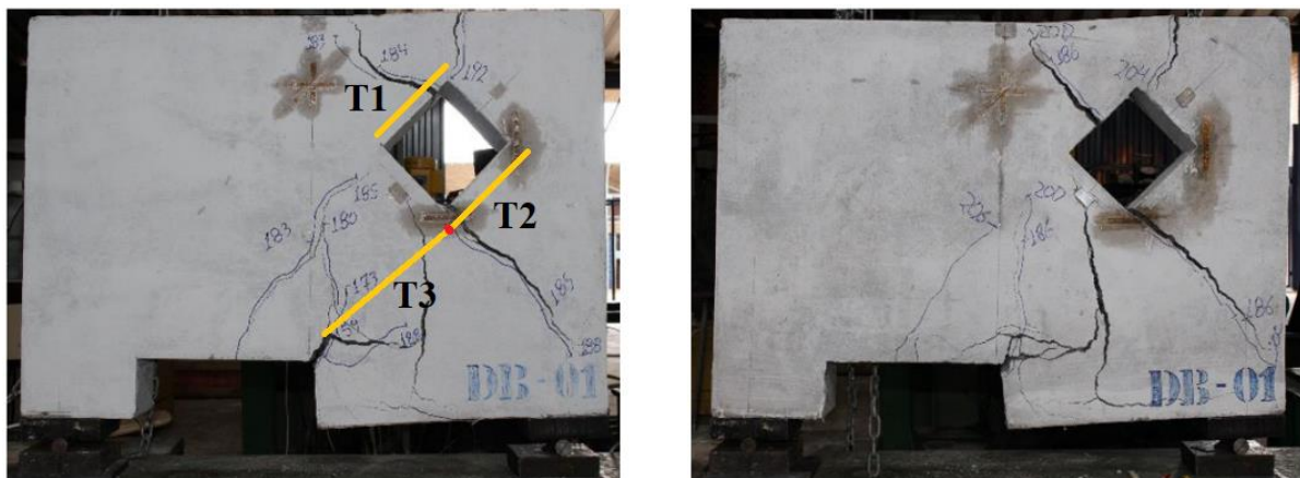
Figura 4. 5 - Modo de Ruptura das duas vigas DB-H1-NR. Adaptado de Neta (2019).
