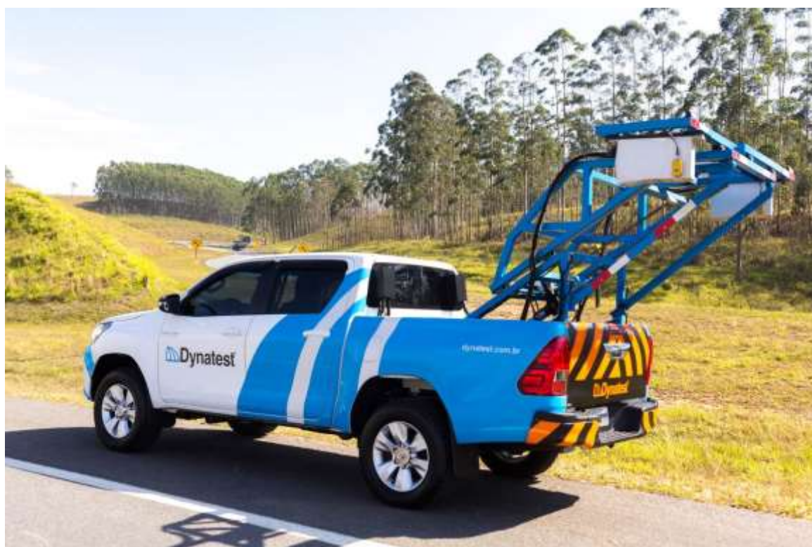
Figura 3.2 Equipamento Pavement Scanner utilizado nos levantamentos (Dynatest, 2021).
