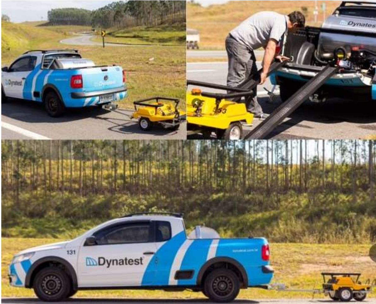
Figura 3.3 Equipamento Grip Tester utilizado pela empresa (Dynatest, 2021).
