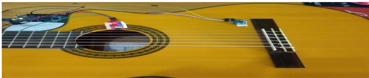
Figura 16: Sensores de som e de vibração ligados ao Arduino DUE medindo as oscilações no tampo superior do violão Profissional
